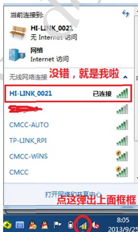
图 2-8 寻找 wifi 模块发送的无线网络信号
